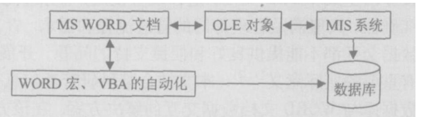
图 2 数据库与 WORD 文档间数据交互的系统模型 Fig 2 System model of data interaction between database and WORD document
